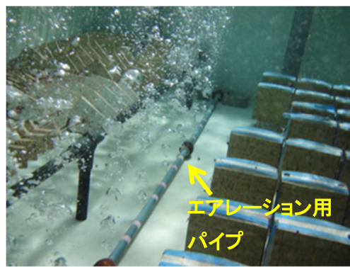
水槽内のエアレーションの状況
