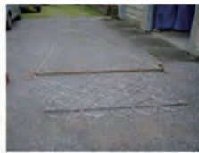
B チェーン曳き器具(ダイヤモンド型、幅2.5m×長さ1.5m)
