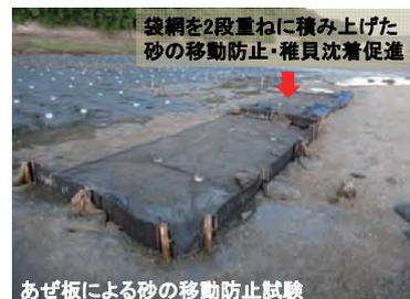
備考:これまで砂の移動が激しく、稚貝の着底が認められなかったが、移動防止施設の背後や、その背後にある食害防止用の被覆網下に、稚貝が多く発生。
