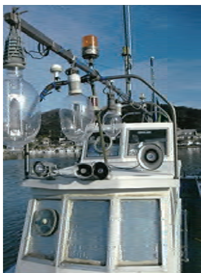
写真1 無線機器の設置(アンテナ)
